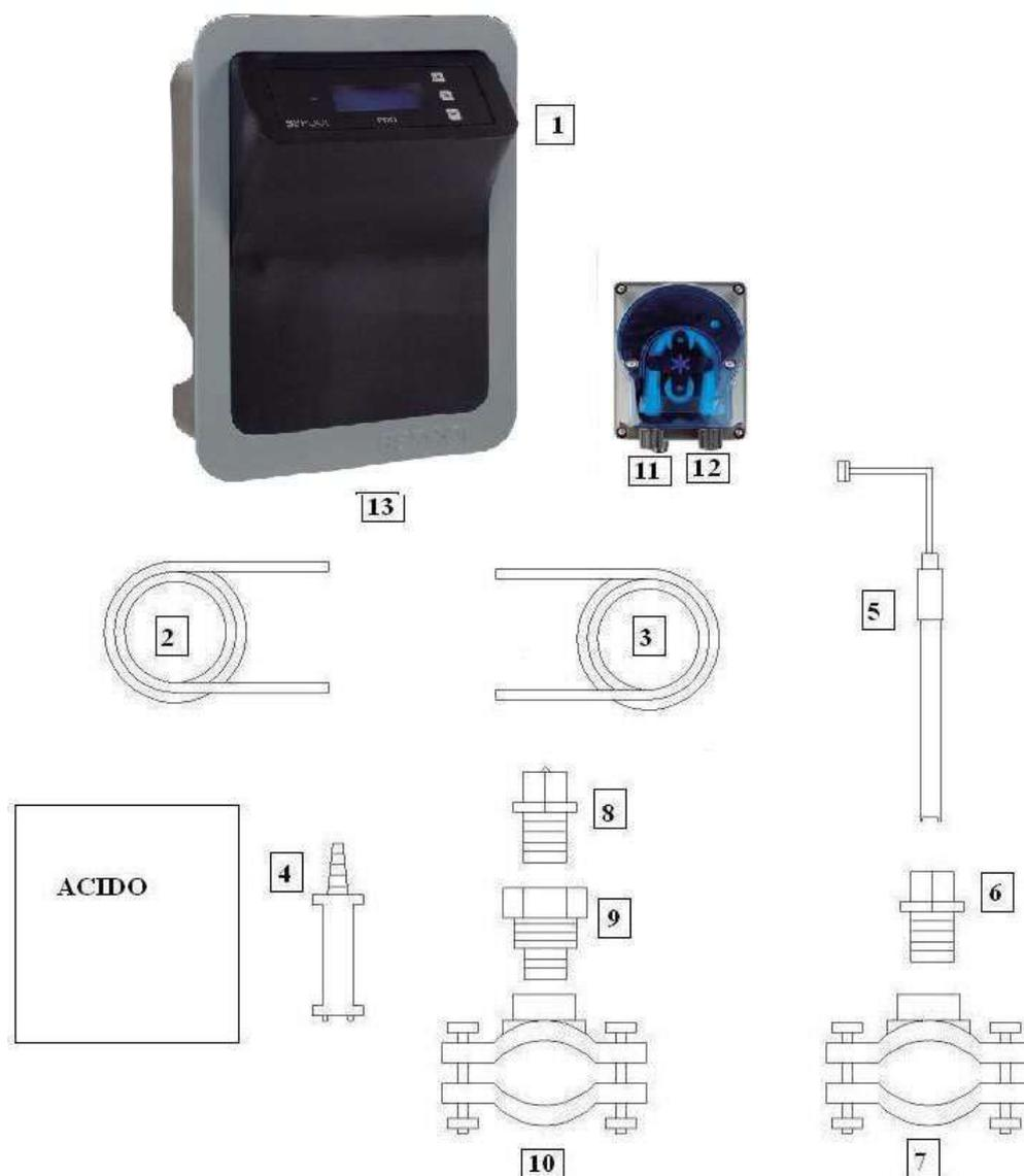
Una vez instalado el equipo (1), debemos realizar las siguientes conexiones.
