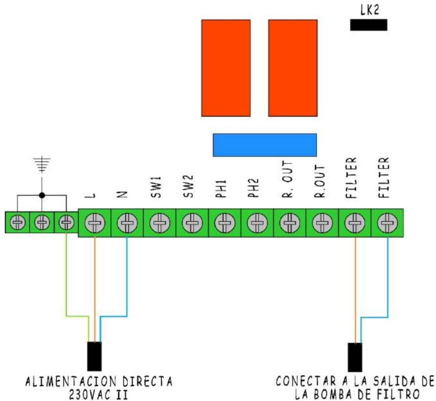
Atención: No superar nunca los 16A cuando utilice el relé auxiliar. Para corrientes mayores, complemente el circuito con un contactor.
