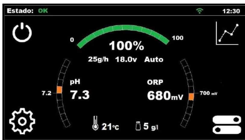
En la línea superior se muestra una visualización del estado del equipo. En la parte derecha de esta línea se puede ver la hora actual, una vez que haya sido configurada. También se puede comprobar la conectividad con EYPOOLS (EYP-004)
