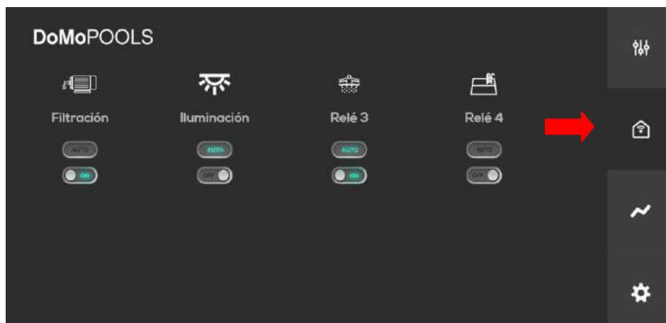
Pulsando directamente sobre el interruptor ON/OFF realizaremos encendido y apagado del mismo. Accionando este interruptor se deshabilita el modo automático.
