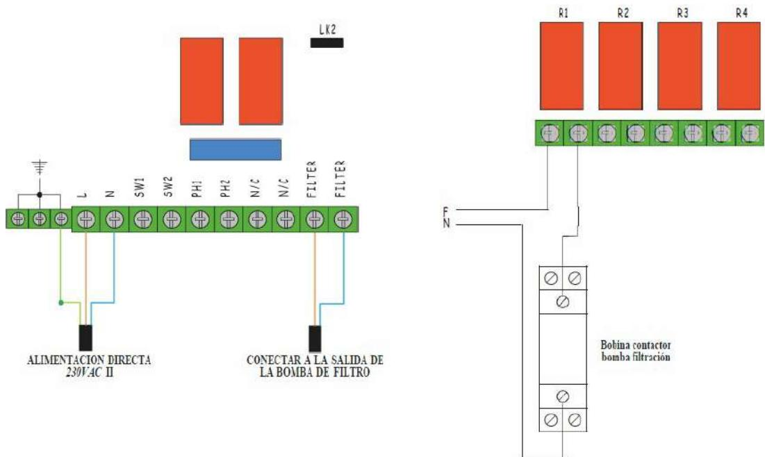
Este tipo de conexionado debe incluir 3 elementos extras: diferencial, guardamotor y contactor. Sirven para proteger el equipo y a la bomba de filtración. En el siguiente esquema eléctrico se puede observar las conexiones
