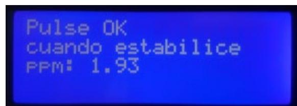
Ajuste el valor real de la medida a partir del obtenido mediante su equipo de medida DPD-1
